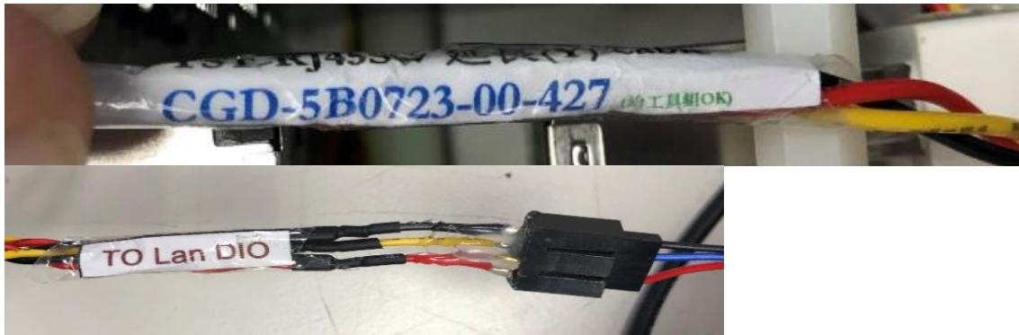
3-3. 如下範例，假設原單治具測試時 LAN1 易受 LAN2 網路訊號串擾.
