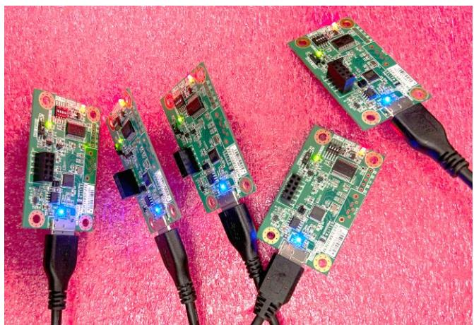
D4. 接上治具後，執行測試參數：UEFI\_U315 /USB20 5 /USB30 5
